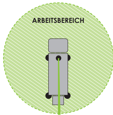
Eingeschränkter Arbeitsbereich bei einseitigem Aufbau
