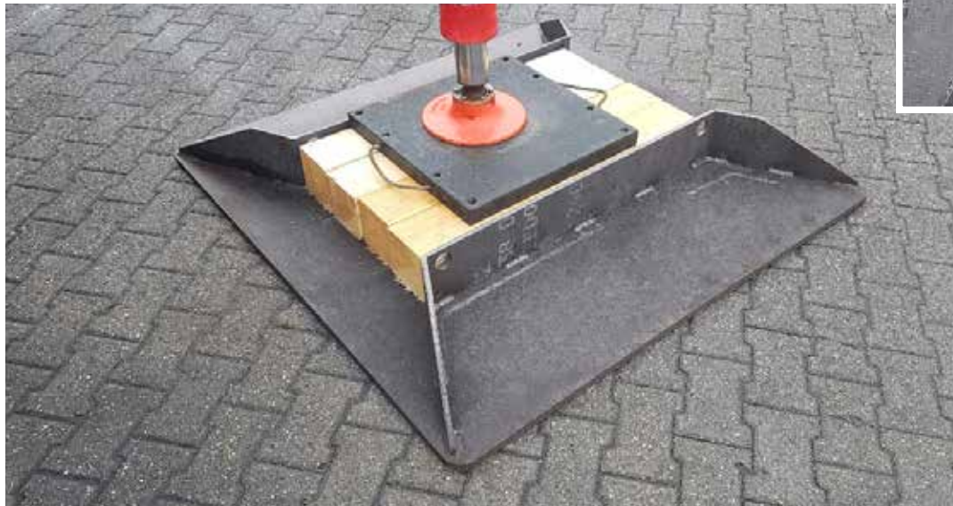
Lastverteilung durch Stahl mit Transportösen
