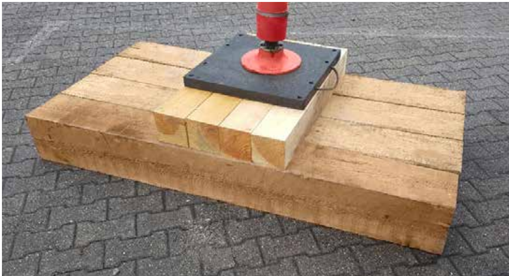
Lastverteilung durch Holz tragbar
